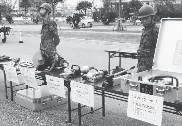
Fig.8 人命救助システム用器材の分隊・小隊・中隊用器材 (エンジンカッター、チェーンソー、油圧式カッター、 切断機、スプレッダなど)
