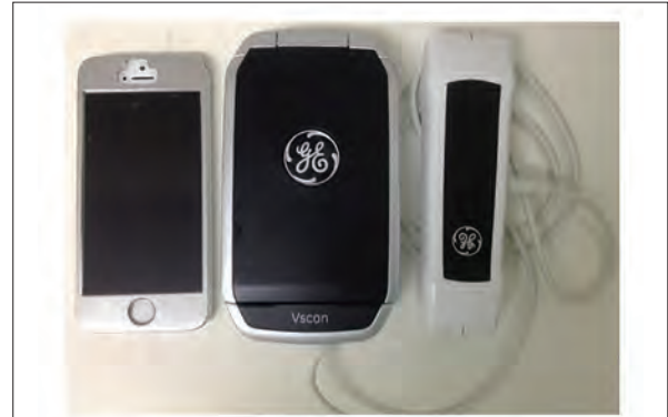
スマートフォンとほぼ同等の大きさ プローブの両端にそれぞれセクタ探触子とリニア探触子を備え、機動性に富むエコー機である
