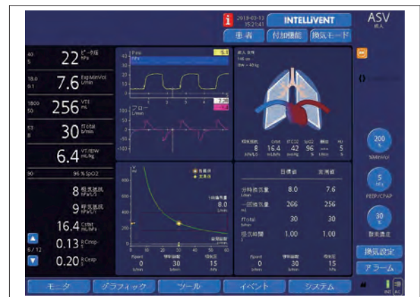
図2 ハミルトン G5 ASV モード 画面右側の % MV、PEEP、酸素濃度およびアラーム設定を設定する必要がある。
