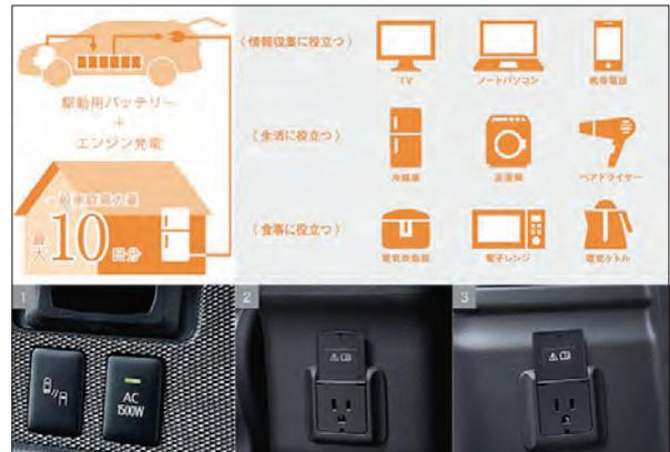
Fig.3 アウトランダー PHEV 外部給電
